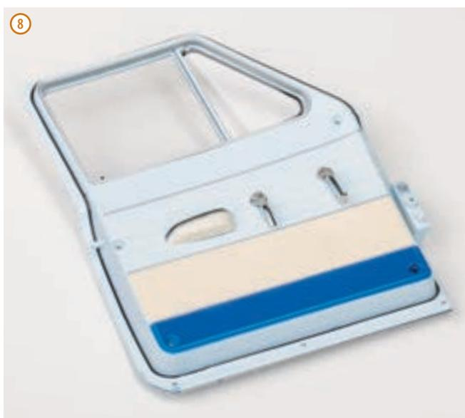
При необходимости поправьте стекло вентиляции и опускающее стекло в оконных проемах. Петля двери не должна мешать монтажу (должна быть направлена вперед). Обратите внимание на положение штыря замка двери: он должен войти в прорезь на торцевой стенке обивки двери.
