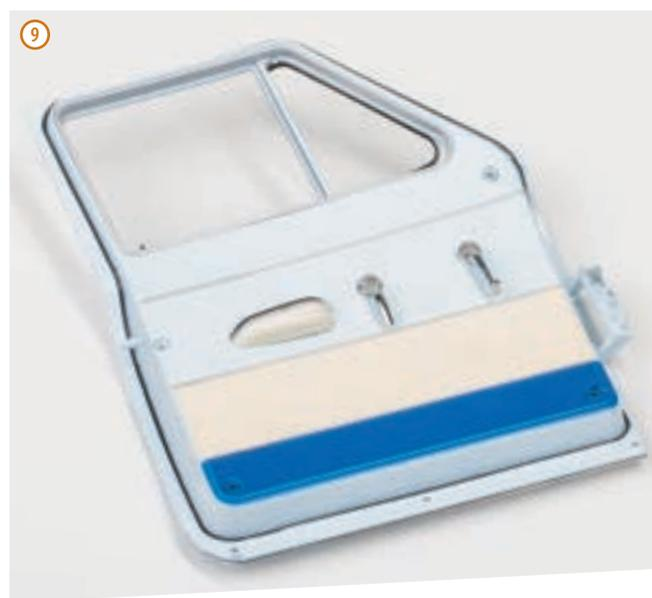
Закрепите обивку на левой передней двери с внутренней стороны при помощи четырех винтов: двух 2,0×6 (OM) в нижней части обивки и двух 2,0×5 (NM) в ее средней части (около стекла вентиляции и позади внутренней ручки).
