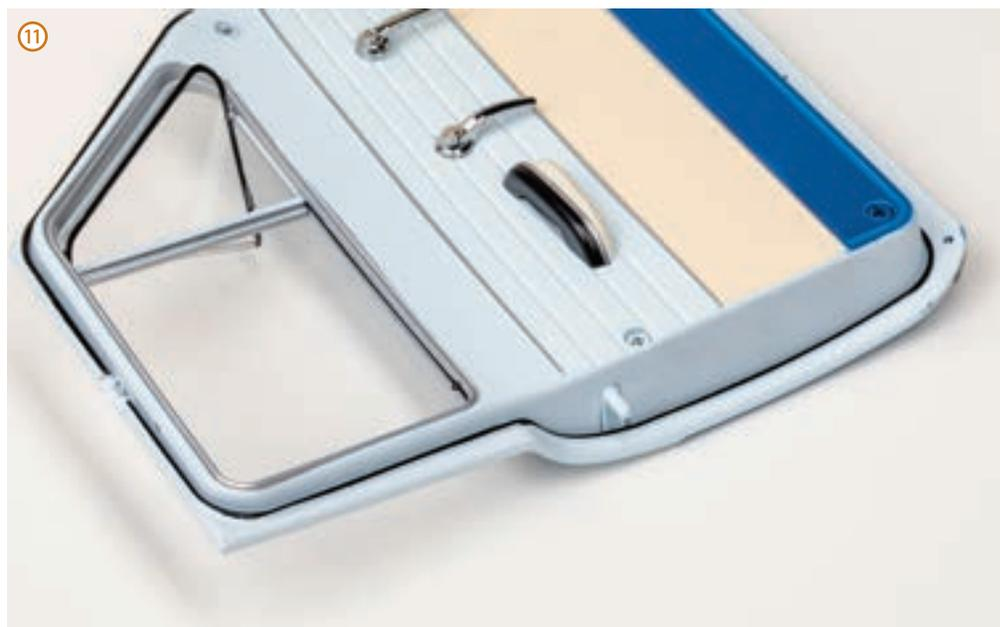
По окончании фиксации проверьте подвижность штыря замка двери и механизма стеклоподъемника.
